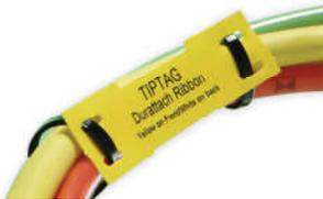
Todos los circuitos deben ser marquillados con etiquetas para acometidas de conductores superiores a 1/0; las etiquetas deben ser en color amarillo de poliolefina sin bordes; se deberán instalar al inicio de la acometida, al final de acometida y en todos y cada uno de los cambios de dirección indicando de donde viene y hacia dónde va el circuito.
